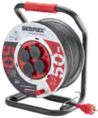
601259 ENROULEUR MÉTAL HO7RN-F 3G1,5 4 PRISES ÉTANCHE IP44 DISJONCTEUR THERMIQUE 50 MÈTRES
