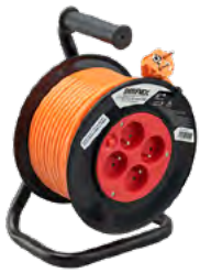
601259 ENROULEUR BRICOLAGE 4 PRISES DISJONCTEUR THERMIQUE HO5VV-F 3G1.5 25 MÈTRES
