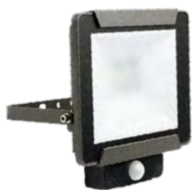
600037 PROJECTEUR A DETECTEUR INFRAROUGE 30W / 6500 K / 2400LM
